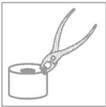
Nach dem Guss Muffeln – an einem geschützten und gekennzeichneten Ort – an der Luft auf Handwärme abkühlen lassen, **nicht in Wasser abschrecken!**
