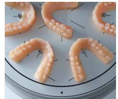
Um bis zu 9 kleine Modelle zu platzieren, die Modellscheibe mit den Schrauben nach unten einsetzen.
