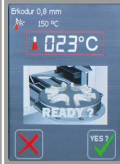
zu 3. Jetzt den Formtopf mit Modellscheibe und den darauf angeordneten Modellen auf den Formtopftisch setzen und bestätigen (yes).
