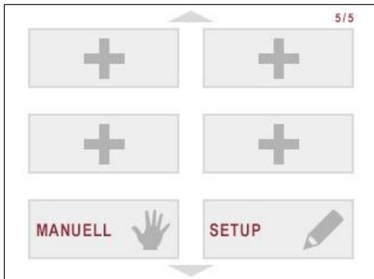
2. Wählen Sie durch Drehen des Drehreglers (2) nach links oder rechts bis zur Bildschirmseite 5 den manuellen Modus aus. Öffnen Sie den Modus durch Drücken auf den Drehregler (2).
