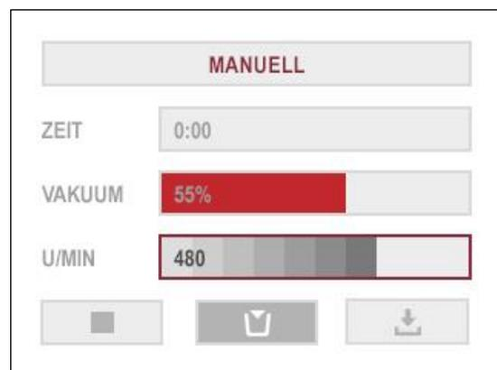
6. Durch Drücken des Drehreglers (2) auf das Becher-Symbol (21) in der Mitte lösen Sie den Becher (9) aus der Becheraufnahme (7), wenn das Programm beendet ist. **Bitte halten Sie den Becher (9) fest.** Daraufhin gelangen Sie automatisch wieder in das Hauptmenü.
